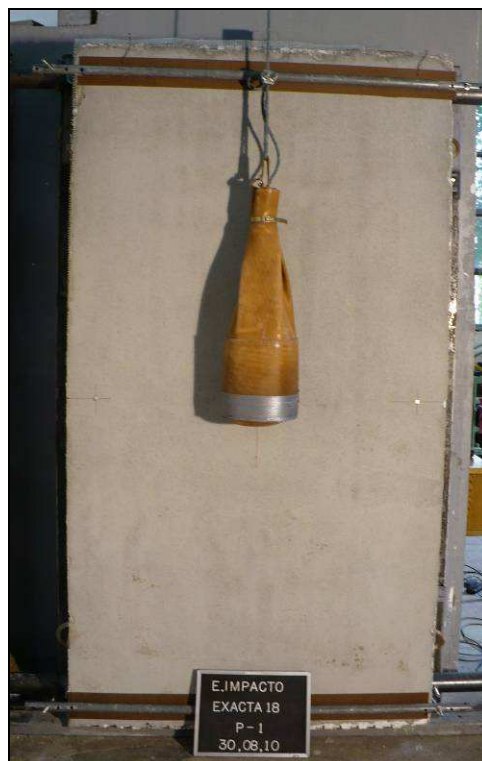
Foto 3. Montaje del ensayo de impacto de cuerpo blando al muro (típico).
