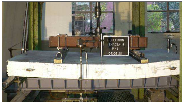
Fotos 4 y 5. Modo de falla de la muestra Nº 1.
