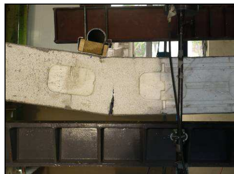
Fotos 8 y 9. Modo de falla de la muestra Nº 3.
