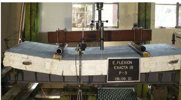
Fotos 8 y 9. Modo de falla de la muestra Nº 3.
