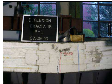
Fotos 4 y 5. Modo de falla de la muestra Nº 1.
