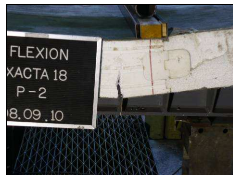
Fotos 6 y 7. Modo de falla de la muestra Nº 2.
