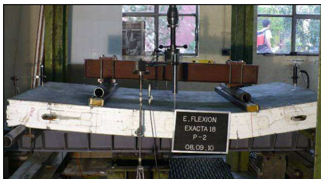
Fotos 6 y 7. Modo de falla de la muestra Nº 2.
