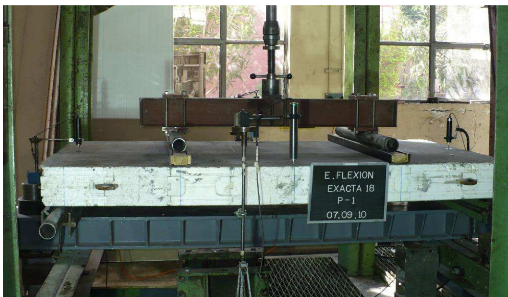
Foto 3. Vista general del montaje del ensayo de flexión al muro.
