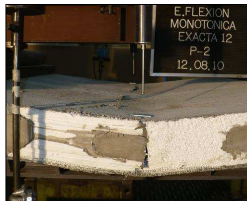
Fotos 6 y 7. Modo de falla de la muestra N° 2.
