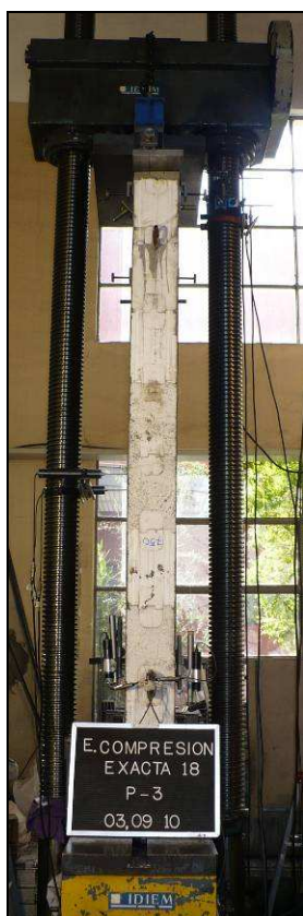
Fotos 3 y 4. Vista general del montaje del ensayo de compresión excéntrica al muro.
