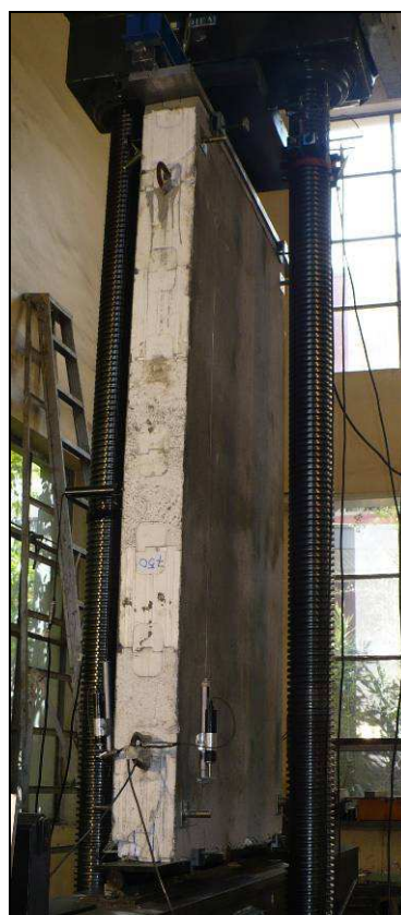
Fotos 3 y 4. Vista general del montaje del ensayo de compresión excéntrica al muro.
