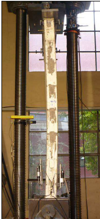
Fotos 4 y 5. Modo de falla de la muestra Nº 1. Falla por flexo-compresión en el tramo central.
