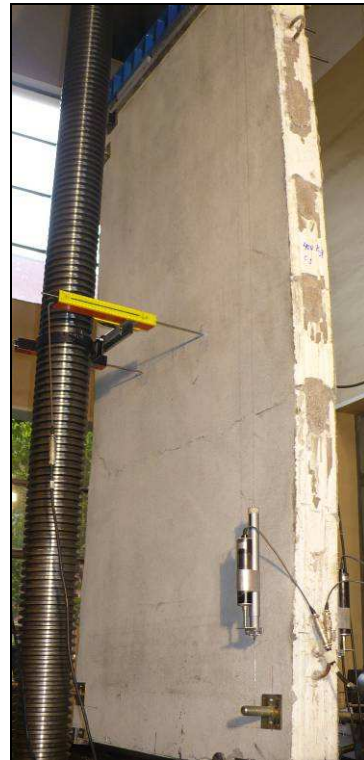
Fotos 4 y 5. Modo de falla de la muestra Nº 1. Falla por flexo-compresión en el tramo central.
