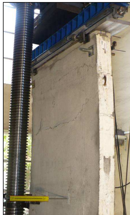
Fotos 6 y 7. Modo de falla de la muestra Nº 2. Falla por flexo-compresión en la zona superior del muro (2ª hilada).
