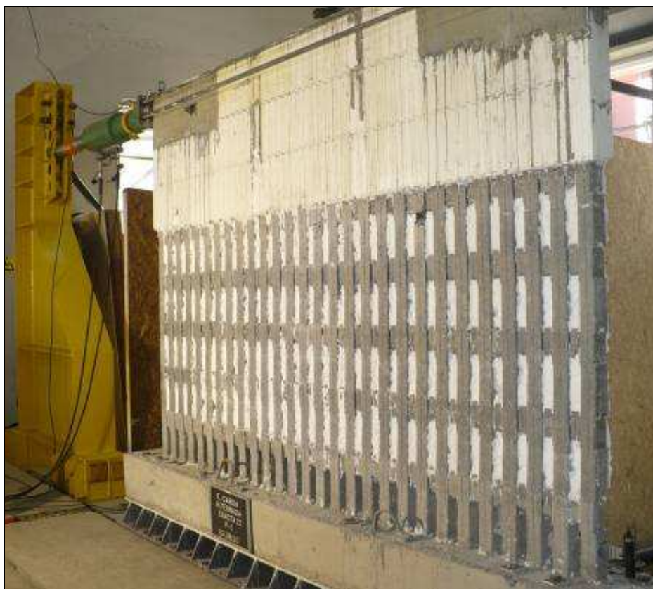
Foto 2. Vista general montaje de ensayo de carga lateral alternada (típico).
