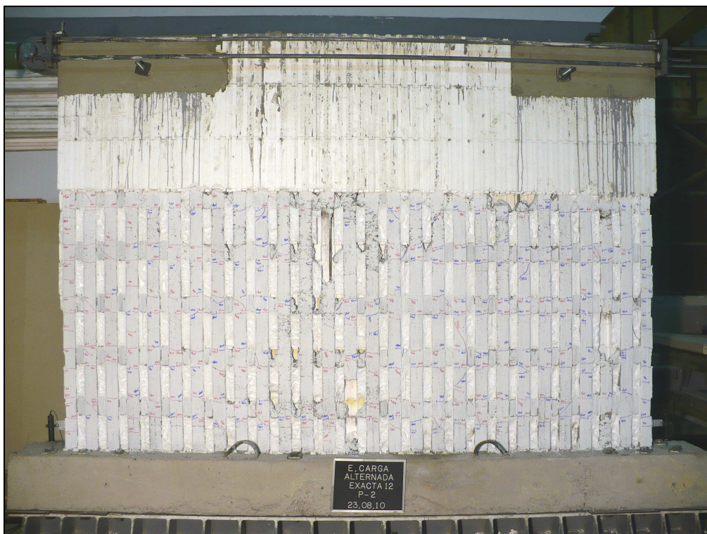
Foto 5. Nivel de daños del muro 2 para el estado límite "Carga máxima" .
